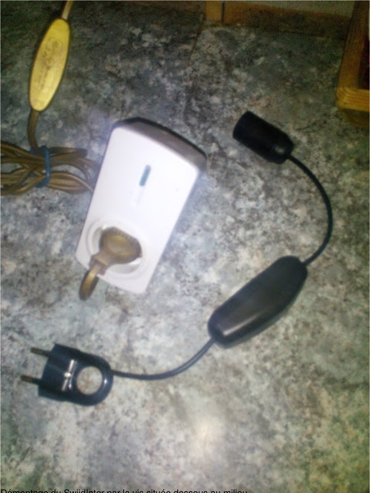
Démontage du SwiidInter par la vis située dessous au milieu
